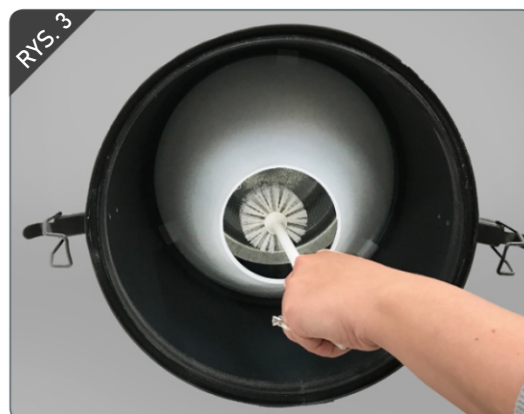
CZYSZCZENIE SIATKI OCHRONNEJ
